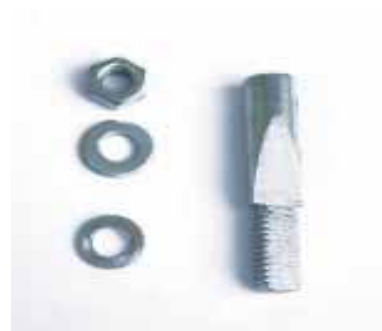
■ CHAVETA AM1400 Código : 14/1430 Material: Aço 8620 temperado Zincado branco
