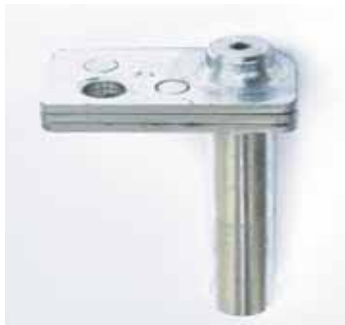
■ EIXO EXCENTRICO Código : 14/1437 D/E Material: Aço 1045 cementado retificado Zincado branco
